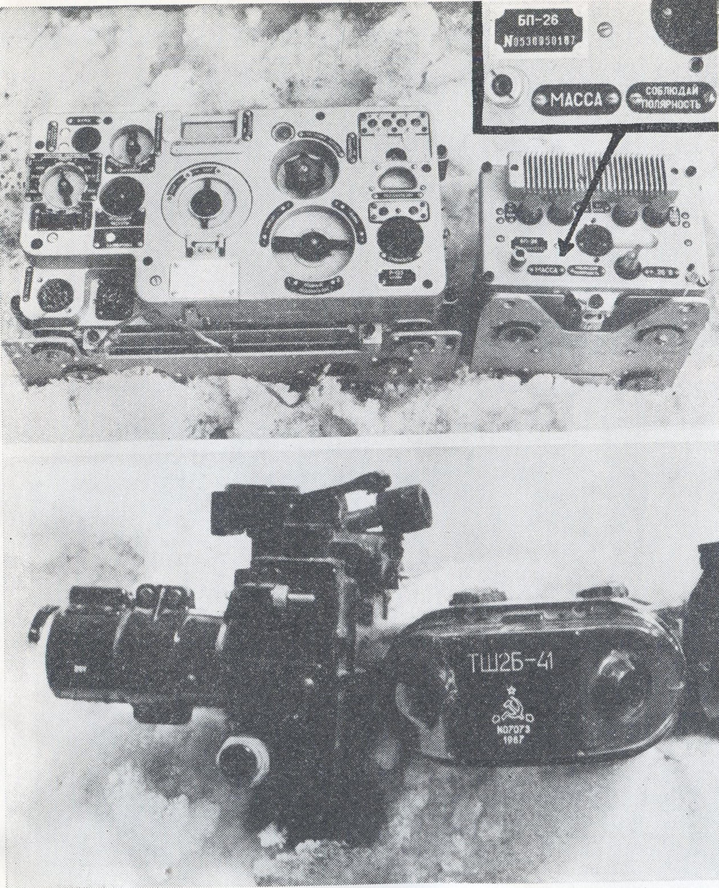
Сняты с танка советских вооруженных сил радиоприемо-передатчик (вверху) и прицел (внизу).
